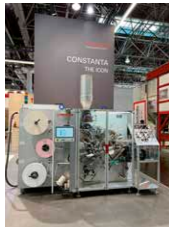
Die Constanta war die erste Verpackungsmaschine für Doppelkammer-Teebeutel.
