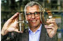
Hermann Heringer zeigt eine Schneckenwelle und ein Schneckenrad.
